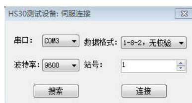
图 2 连接伺服通讯端口
